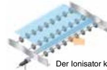
Der Ionisator kann an Orten installiert werden, an denen sich ein konventioneller Typ nicht montieren lässt, d.h. er kann besonders nah an Objekten platziert werden, deren elektrostatische Aufladung entfernt werden soll.
