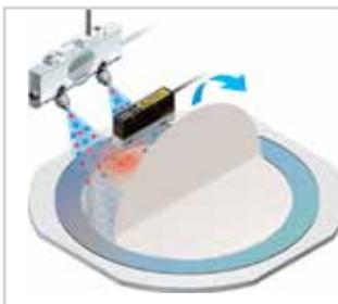
**Elektrostatische Aufladungen an Lead frame messen**
