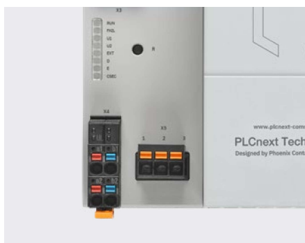
Überwachung durch integrierten Watchdog und Live-Relaiskontakt
