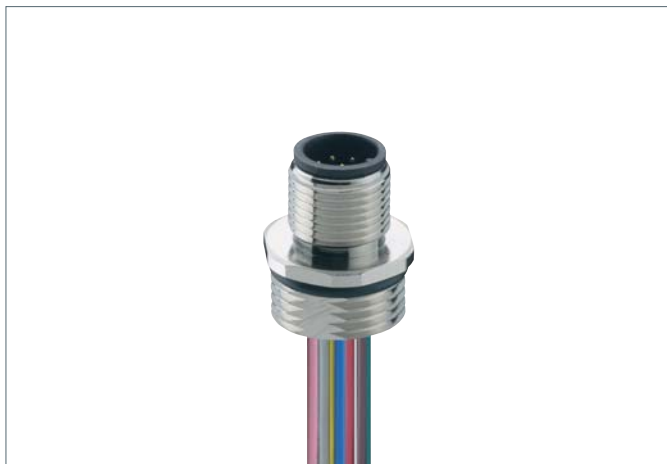
M12-Einbaustecker, A-kodiert, IP 67, für Frontmontage, Verschraubung M16, mit Litzen
