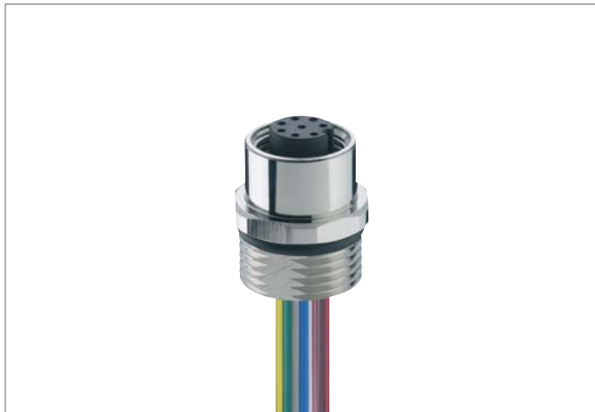
M12-Einbaukupplung, A-kodiert, IP 67, für Frontmontage, Verschraubung M16, mit Litzen
