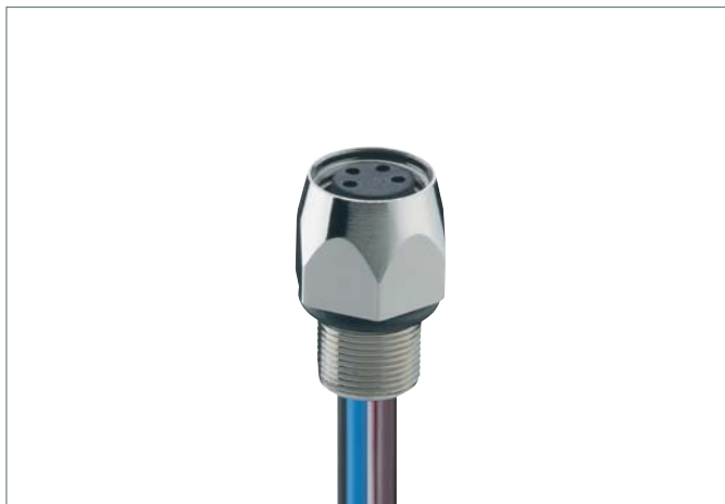
M8-Einbaukupplung, A-kodiert, IP 67, für Frontmontage, Verschraubung M8, mit Litzen
