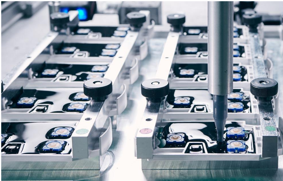
Bild: Für den Verguss optimiert: Kurzhubtaster RACON 12 S
